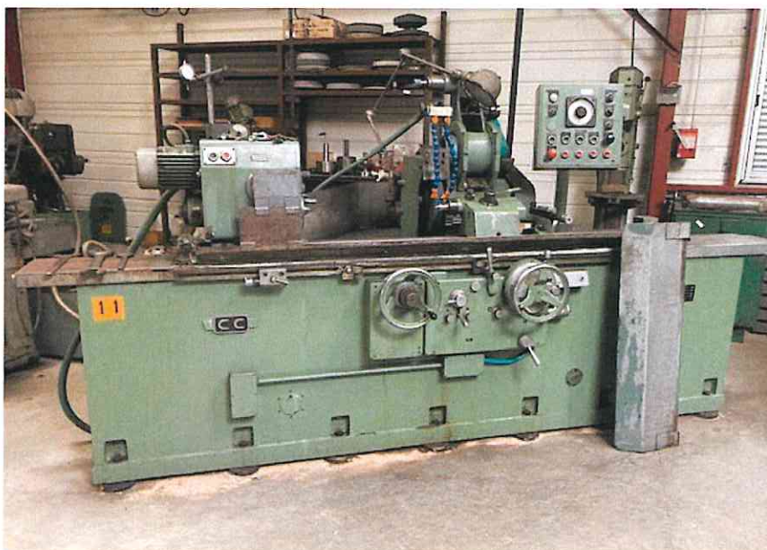
145 Une rectifieuse cylindrique de marque CC, entrepointe et équilibrée avec outillage Estimation 500 /800
